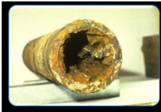
Corrosión externa de tuberías de fundición dúctil.
