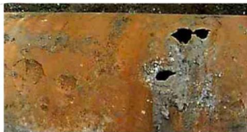
Corrosión externa de tuberías de fundición dúctil.
