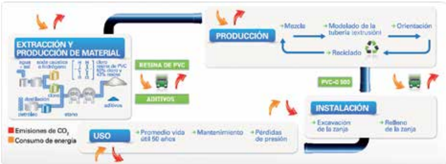
Ciclo de vida de un sistema de tuberías de PVC-O TOM®
