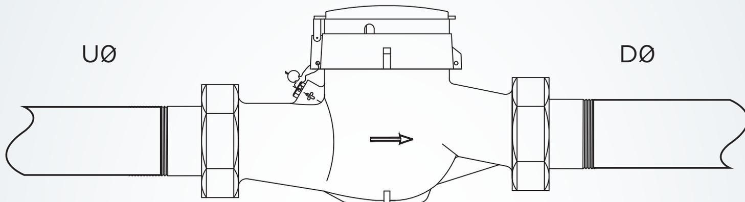
Nuestro contador MFSM-L no necesita tramos rectilíneos ni a la entrada ni a la salida.
