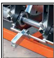
Despegue automático de la placa térmica
