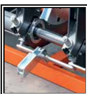
Despegue automático de la placa térmica
