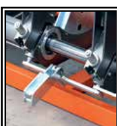
Despegue automático de la placa térmica
