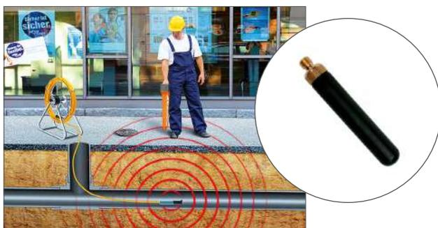
A sonda transmissora MLS 55-3 é um mini-transmissor compacto, alimentado por bateria, com um alcance de 5 m. Quando fixado a uma haste de esgoto ou a um cabo de empurrar em fibra de vidro através de um dos 3 adaptadores fornecidos, é utilizado para localizar condutas ou obstruções. Está disponível uma proteção robusta para trabalhos exigentes.
