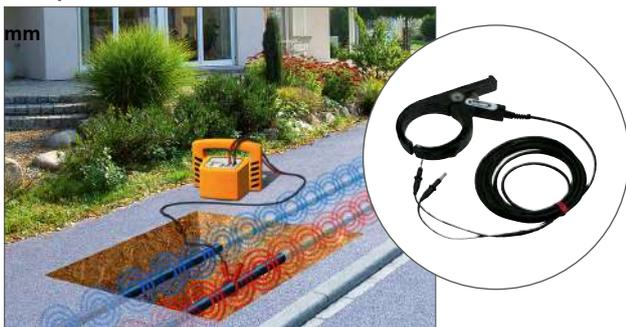
O grampo transmissor Easyclamp é utilizado para enviar o sinal de 33 kHz para cabos em funcionamento, sem necessidade de os desligar. O Easyclamp liga-se ao transmissor Easyloc TX e instala-se à volta do cabo, permitindo um rastreamento eficaz do traçado.
